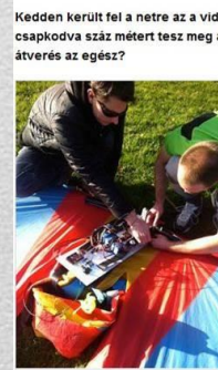
A szárny irányítószerkezetének szerelése
